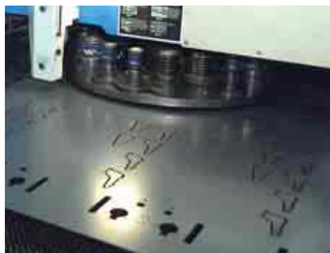
Taglio laser e punzonatura automatizzata.
